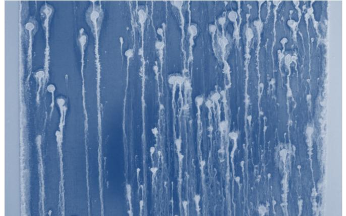
Essai au brouillard salin
